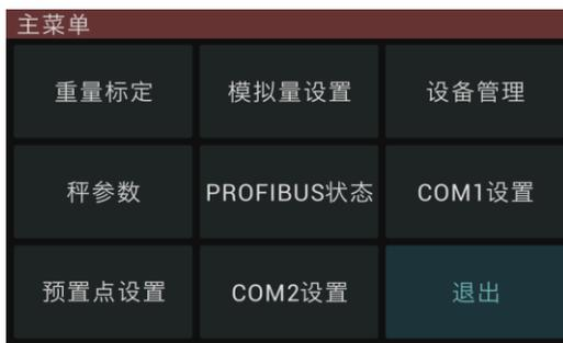
3、按“重量标定”，输入密码（默认“123”），弹出标定流程选择界面，推荐选择“砝码标定”
